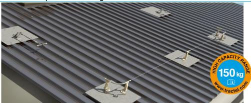
El sistema de un solo cable Travflex 2 proporciona un recorrido suave. Permite que el deslizador se mueva libremente sobre los anclajes intermedios, minimizando el desgaste y eliminando la asistencia al usuario. Las manos del usuario permanecen libres para realizar cualquier tarea que se requiera. Está diseñado para limitar las fuerzas transmitidas a la estructura en caso de caída para su instalación en estructuras ligeras como el techo de cubierta de acero.
